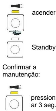
Se o LED acima da tecla **Alarme** acender a amarelo, é necessária a manutenção por parte do seu técnico de serviço. O modo de intervalo é continuado. A respetiva mensagem é registada no cartão SD. O relé de alarme não comuta.
